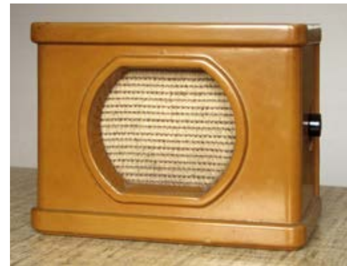
12. Kołchoźnik, czyli głośnik radiowęglowy GD-16,5/2
